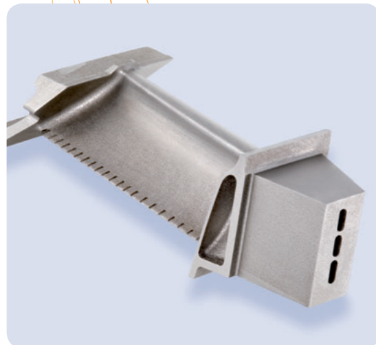
Turbinenschaufel mit Innenkühlung Werkstoff CL 100NB ( Inconel 718 ) Originalgröße 41 x 65 x 152 mm
