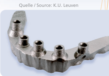
Unterkieferprothese Werkstoff CL 40TI ( TiAl6V4 ) Originalgröße 50 x 35 x 15 mm
