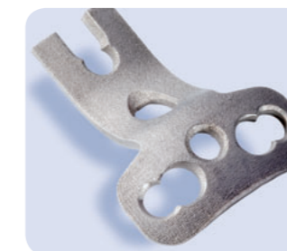
Knochenplatte Werkstoff CL 40TI ( TiAl6V4 ) Originalgröße 45 x 30 x 15 mm
